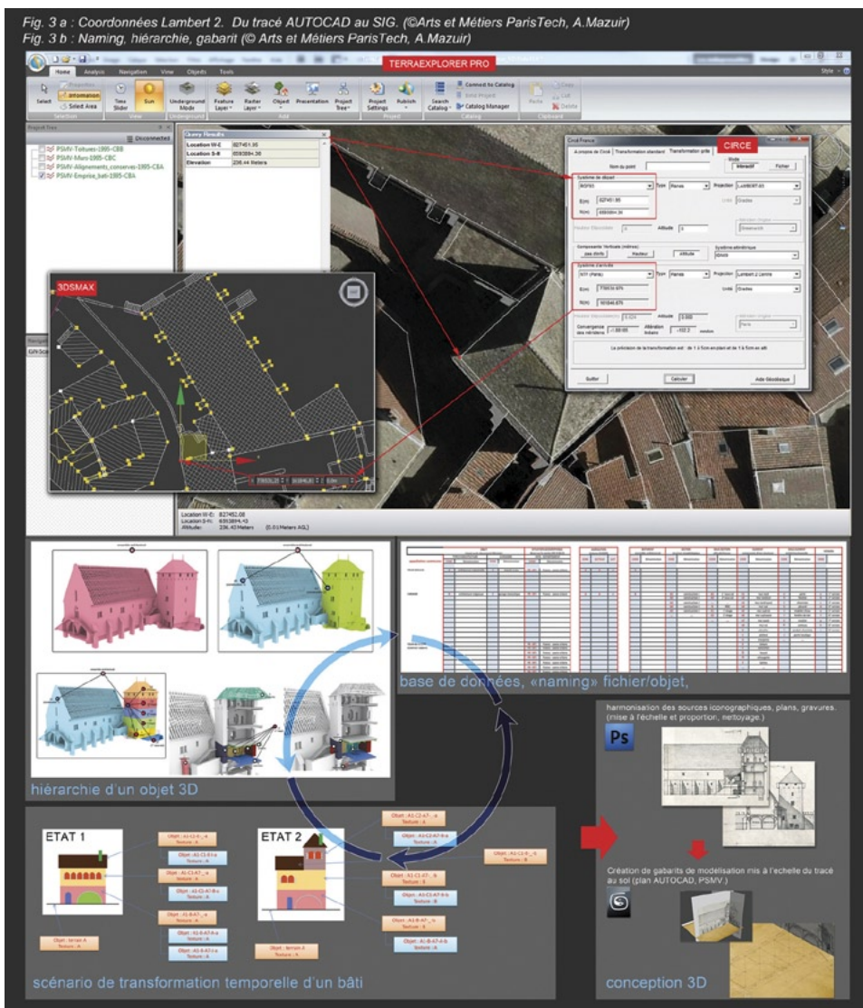
Fig. 3 – a. Coordonnées Lambert 2. Du tracé AutoCAD au SIG (Arts et Métiers ParisTech, A. Mazuir); b. Naming, hiérarchie, gabarit (Arts et Métiers ParisTech, A. Mazuir).
