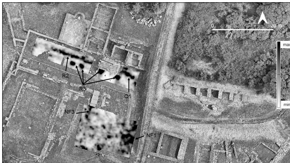
Fig. 6 – Rusellae, settore N del Foro, Portico Nord. GPR time slices alla profondità stimata di 0,60 m.
