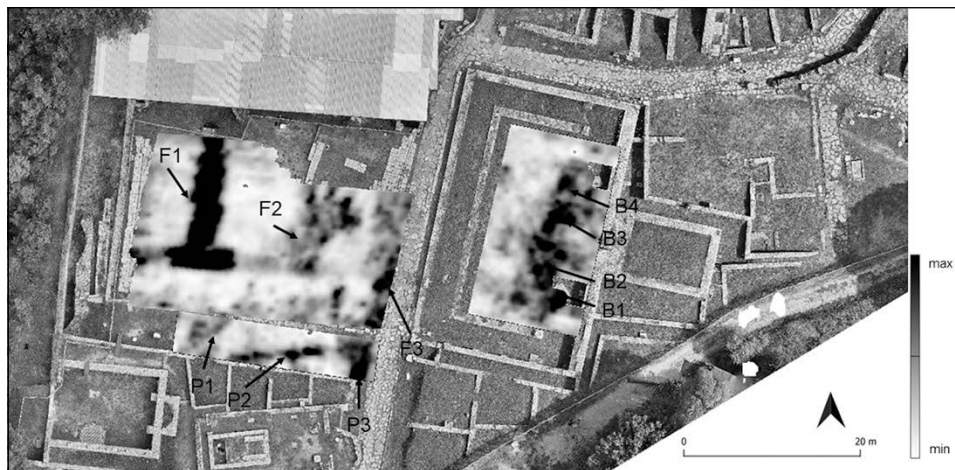
Fig. 3 – Rusellae , settore S del Foro, Portico Sud, Basilica. GPR time slices alla profondità stimata di 0,40 m.
