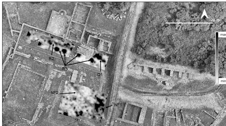
Fig. 7 – Rusellae , settore N del Foro, Portico Nord. GPR time slices alla profondità stimata di 0,90 m.
