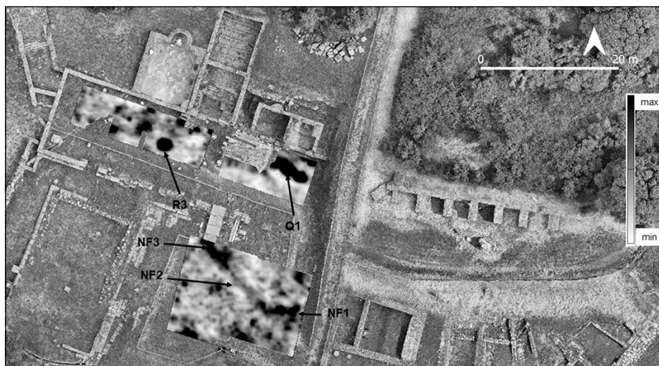
Fig. 9 – Rusellae , settore N del Foro, Portico Nord. GPR time slices alla profondità stimata di 1,70 m.
