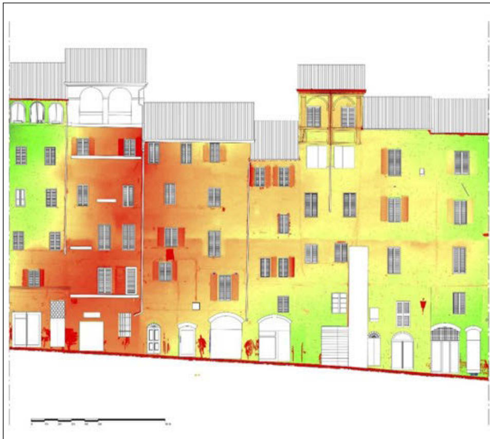
Fig. 1 – Elevation map di una porzione di fronte stradale di via Pendola nel centro storico di Siena. Nell'elaborato vengono evidenziate le deformazioni della struttura mediante una scala cromatica di riferimento (dove il rosso rappresenta le porzioni maggiormente deformate e il verde quelle meno interessate dagli spostamenti).
