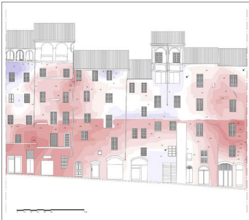
Fig. 2 – Elevation map sviluppato all'interno del progetto PROTECT per una porzione di via Pendola nel centro storico di Siena. In questo prodotto è possibile non solo apprezzare le deformazioni della superficie esterna del fronte stradale, ma anche quantificare nel dettaglio gli spostamenti e proporre linee di propagazione che possano descrivere al meglio ogni singola deformazione (le isoipse che rappresentano le deformazioni sono impostate su un Delta di 2 cm).
