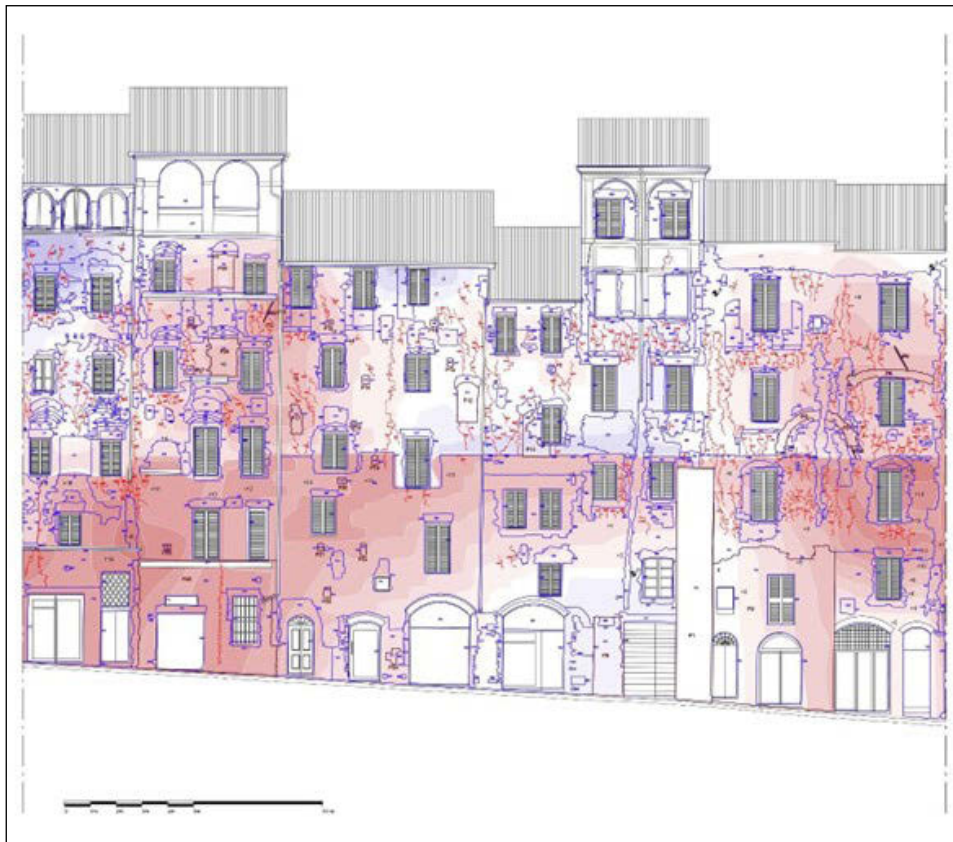
Fig. 3 – Mappa del dissesto stratificato. Si tratta di un elaborato che utilizza come base la Elevation Map sviluppata nel progetto PROTECT alla quale vengono sovrapposti e relazionati altri tipi di informazioni, quali: la lettura archeologica del fronte stradale realizzata per USM (linee blu), il quadro fessurativo (linee rosse), le tecniche costruttive non tradizionali (linee nere).
