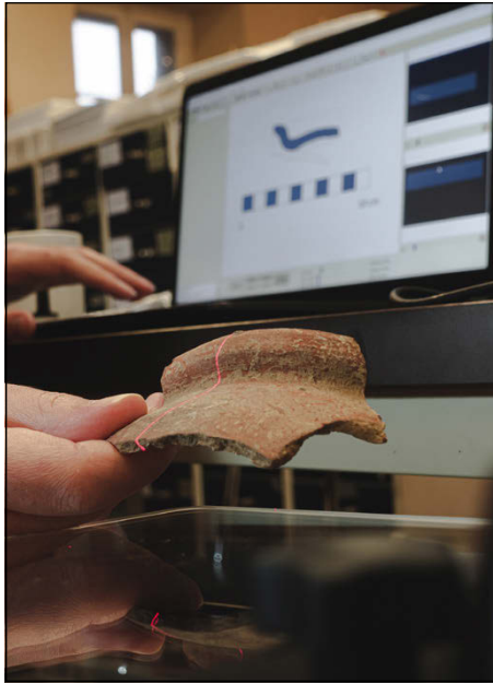
Fig. 1 – Dettaglio del Laser-Aided. In primo piano: proiezione del fascio laser sul frammento. Sullo sfondo: schermata di lavoro del software per la digitalizzazione.
