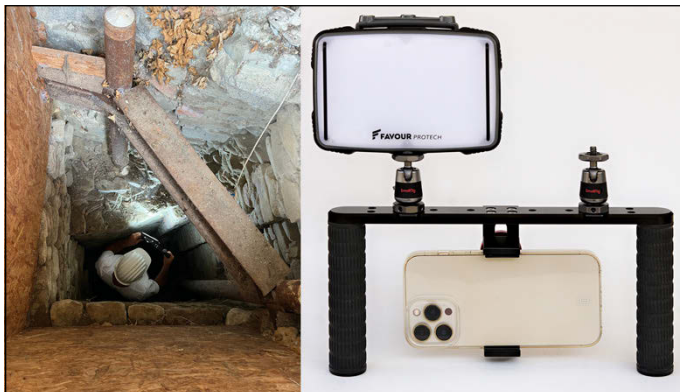
Fig. 1 – Attrezzatura per scansioni dinamiche: smartphone con sensore LiDAR (iPhone 13 Pro Max), struttura metallica con manopole in gomma (Neewer Rig Video) e lampada LED. Questo setup consente il rilevamento in ambienti dove lo spazio operativo è limitato. A sinistra: foto delle operazioni di rilievo presso l'abbazia di San Giovanni Battista (Casola Valsenio, RA).
