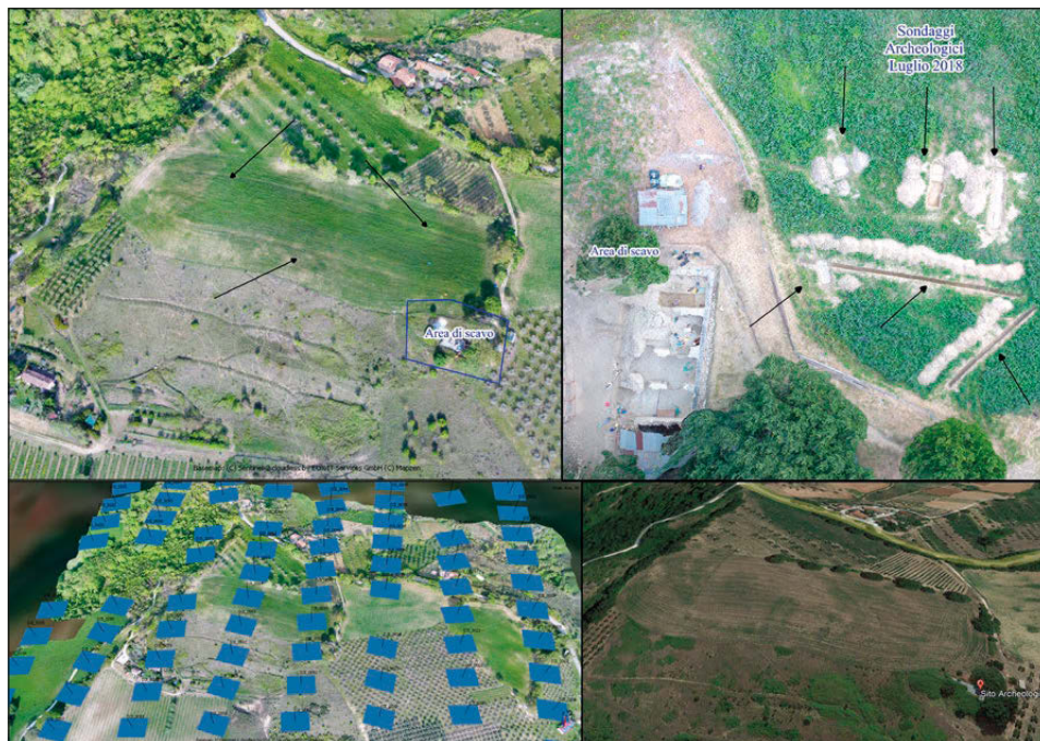
Fig. 3 – Poggio Gramignano (TR), Aerial Remote Sensing mediante UAV: in alto a sinistra, ortofoto da drone con individuazione di anomalie superficiali riconoscibili come variazioni cromatiche e vegetazionali (cropmark e soilmark) in relazione all'area di scavo; in alto a destra, dettaglio dell'area indagata con evidenziazione dei sondaggi archeologici effettuati nel luglio 2018; in basso a sinistra, distribuzione dei fotogrammi e delle prese di volo utilizzate per la ricostruzione fotogrammetrica; in basso a destra, vista obliqua dell'area di Poggio Gramignano e del contesto paesaggistico circostante (elab. grafica R. Montagnetti 2025).
