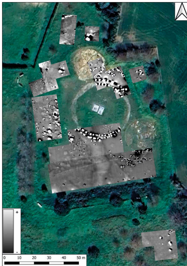
Fig. 6 – Risultati delle indagini geomagnetiche effettuate entro l'area archeologica.
