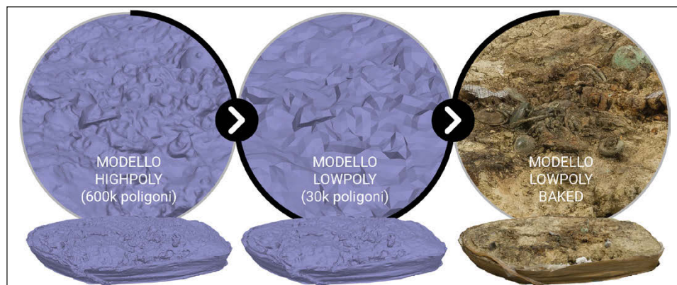
Fig. 7 – Step principali nel processo di elaborazione della replica digitale di una delle fasi di scavo.
