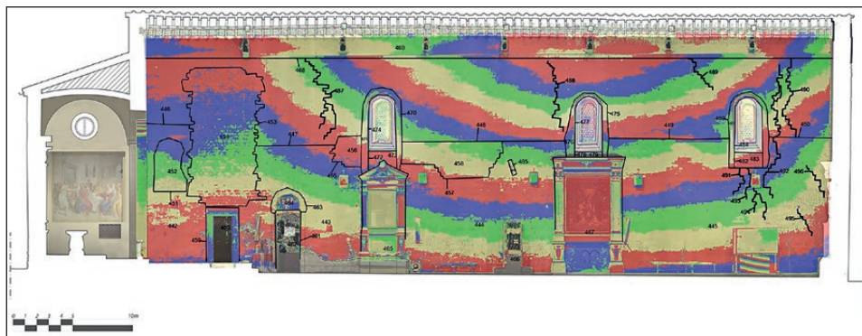
Fig. 8 – Sezione del perimetrale interno S della Pieve di Sant'Agata nella situazione pre-sisma del 2019 con la sovrapposizione tra il quadro deformativo per curve di livello e la stratigrafia (in nero) (rilievo e restituzione: M. Repole; coordinamento: A. Arrighetti, G. Minutoli).
