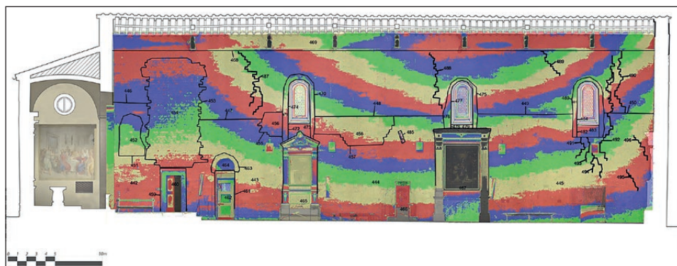
Fig. 9 – Sezione del perimetrale interno S della Pieve di Sant'Agata nella situazione post-sisma del 2019 con la sovrapposizione tra il quadro deformativo per curve di livello e la stratigrafia (in nero) (rilievo e restituzione: M. Repole; coordinamento: A. Arrighetti, G. Minutoli).
