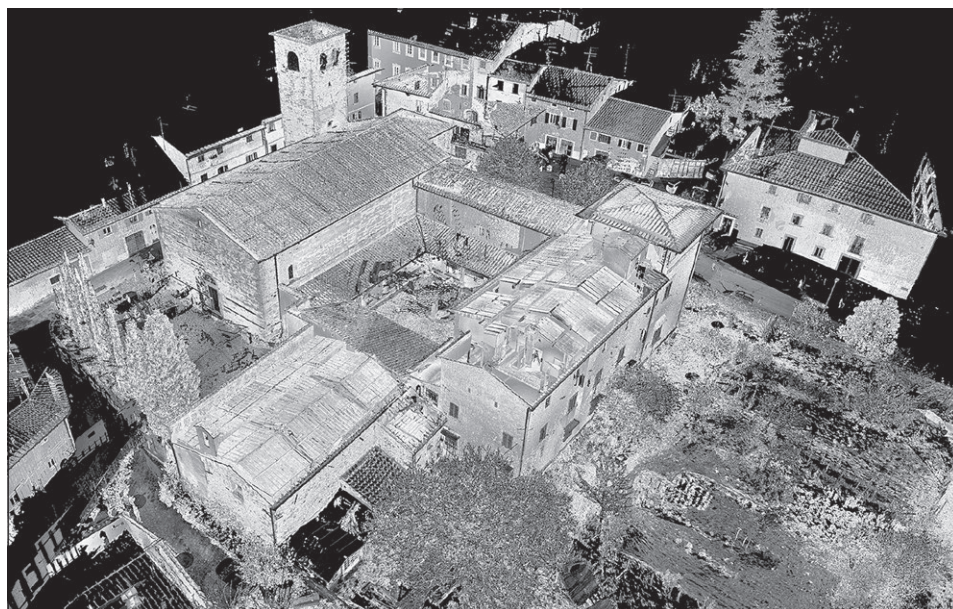
Fig. 1 – Nuvola di punti del complesso architettonico di Sant'Agata ottenuta dal rilievo laser scanner (rilievo: Marco Repole; coordinamento: Andrea Arrighetti e Giovanni Minutoli).
