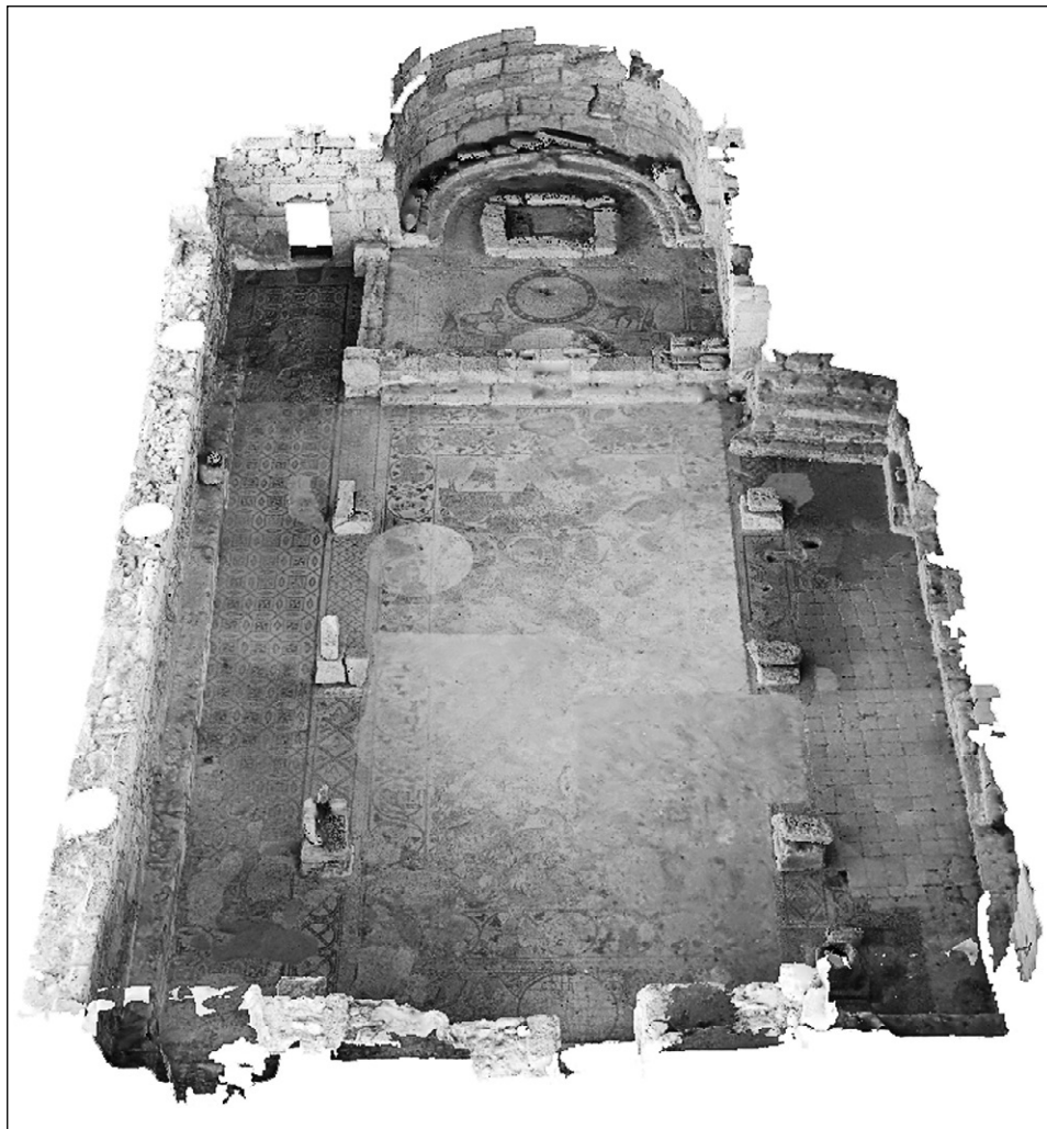
Fig. 2 – Vista prospettica del modello mesh triangolato con sistemi di ripresa laser scanner, chiesa del Vescovo Sergio.
