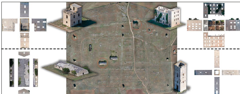
Fig. 4 – Ortofotocarta e prospetti, piani di copertura e assonometria degli edifici rilevati (R. Pavone).
