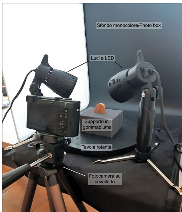
Fig. 2 – Setup per l'applicazione fotogrammetrica al rilevamento di manufatti litici.
