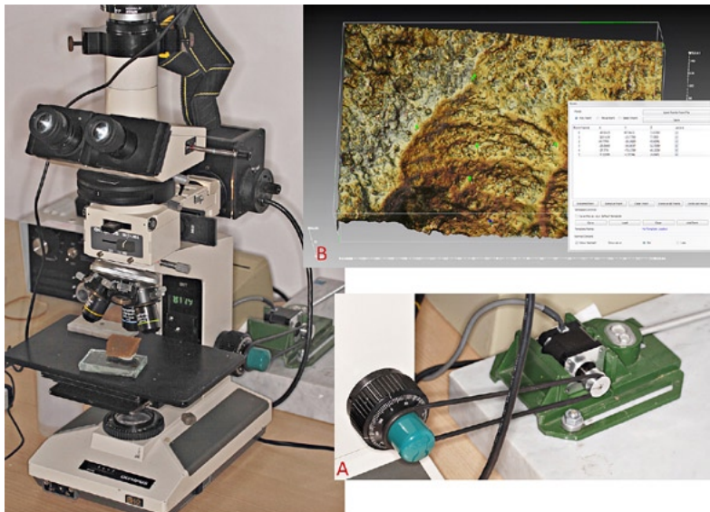
Fig. 4 – Acquisition et modélisation 3D au microscope optique: A. Moteur pas à pas pour prise de vue séquencée; B. Modélisation de l’usure microscopique d’une pointe moustérienne, Angé, France, calibrée dans le module pour Meshlab depth map importer programmé par E. Delord (Archéovision), à partir d’une carte de profondeur produite avec Helicon Focus. Echelle micrométrique.
