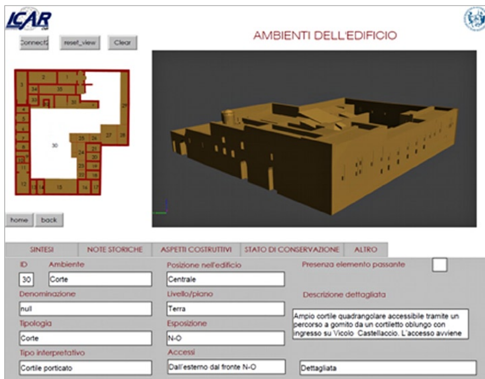
Fig. 5 – Esempio di informazioni ottenibili dal DB collegato al modello 3D, relative agli ambienti dell'edificio.
