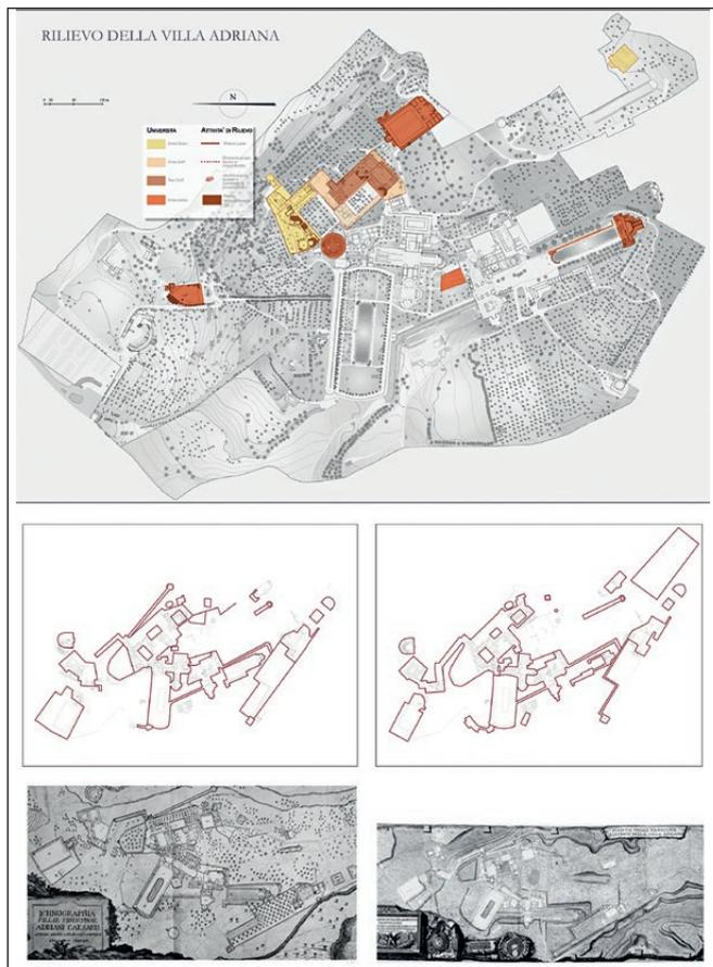
Fig. 1 – Villa Adriana, individuazione delle aree rilevate con metodologie remote sensing. In basso confronti fra la topografia attuale (in evidenza) e le restituzioni delle principali fonti di cartografia storica (dott. arch. F. Greco).
