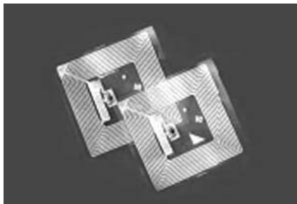
Fig. 6 – Tecnologia RFID: struttura interna degli smart tag.
