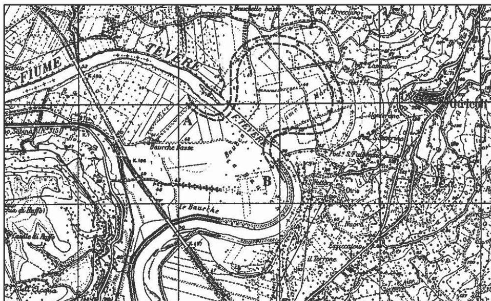
Fig. 9 - Schema di processi di migrazione e salto di meandro lungo l'alveo del fiume Tevere (schema A-B); area di Otricoli, tavolette Otricoli e Orte, scala 1:25.000, stralcio.
